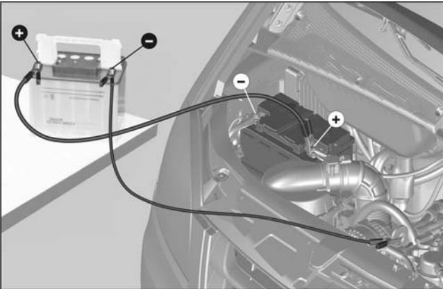
Если аккумуляторная батарея Вашего автобуса разряжена, двигатель можно пустить от батареи другого автомобиля. При этом, обе батареи должны иметь одинаковое номинальное напряжение (12 В) и приблизительно одинаковую емкость (А·ч.). Соединительные кабели должны иметь достаточное сечение.
