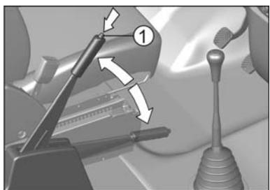
Для затормаживания автобуса стояночным тормозом плотно затяните рычаг, потянув его вверх. Для облегчения перемещения рычага одновременно нажмите на педаль тормоза. При стоянке на уклоне затягивайте рычаг по необходимости сильнее,
