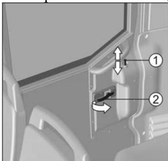
Изнутри замок двери может быть заблокирован нажатием на кнопку 1. При опущенной кнопке 1 дверь нельзя открыть снаружи.
