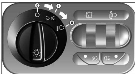
Переключатель имеет три фиксированных положения:
