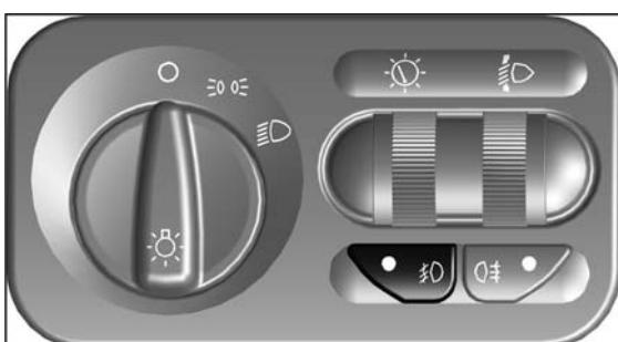
Включение передних противотуманных фар происходит при нажатии на клавишу выключателя при включенных габаритных огнях. При этом в клавише загорается контрольный индикатор включенного состояния передних противотуманных фар.
