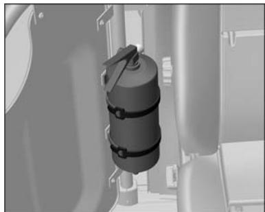
Автобус комплектуется огнетушителем ОП-2, который закреплен на поручне кабины справа от сиденья водителя.
