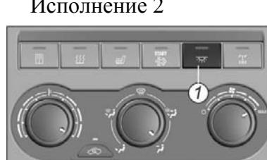
Для включения или выключения плафонов салона нажмите кнопку 1, расположенную в центральной части панели приборов.
