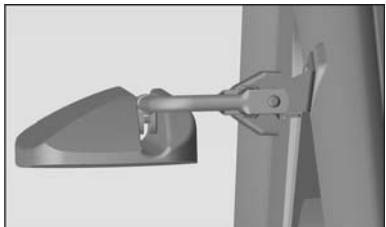
Зеркало оснащено механизмом складывания (травмобезопасности). В случае наезда зеркалом на препятствие, зеркало вместе со стойкой отклоняется в сторону удара.
