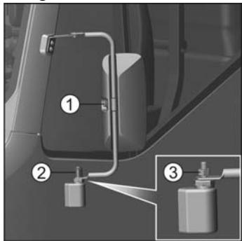
Для регулировки зеркала относительно стойки снимите декоративный колпачок с болта 1, ослабьте болт 1, отрегулируйте зеркало и затяните болт моментом 10,78-15,69 Н·м (1,1-1,6 кгс·м).
