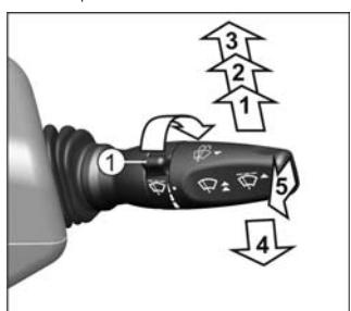
интервале от 2с до 12с в зависимости от положения регулятора паузы 1, которое выбирается поворотом регулятора в направлении стрелки, как показано на рисунке.
