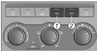
Для включения левого ряда плафонов салона нажмите кнопку 1, правого ряда – кнопку 2, расположенные в центральной части панели приборов. Для выключения плафонов нажмите повторно соответствующую кнопку.
