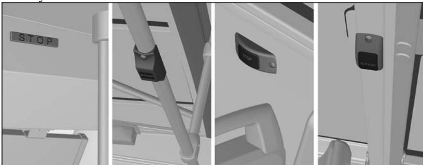
При нажатии на кнопку раздается трехкратный звуковой сигнал водителю и включается сигнализатор «STOP» в комбинации приборов в мигающем режиме. Одновременно с этим загорается световое табло «STOP» в передней части автобуса. Сигнализатор в комбинации приборов и световое табло продолжают гореть до открытия двери на остановке.
