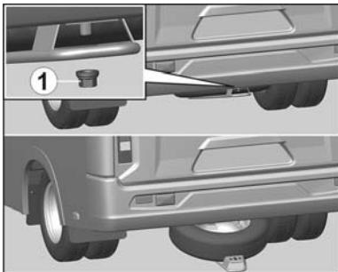
Для снятия запасного колеса, придерживая держатель, отверните баллонным ключом гайку 1 крепления держателя к кронштейну, опустите колесо с держателем и выньте колесо.
