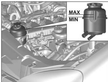
Уровень масла в бачке должен быть между метками, нанесенными на щупе крышки, обозначающими допустимый максимальный и минимальный уровень масла, при завернутой до упора крышке. Проверку уровня масла в бачке производите на холодном двигателе.
