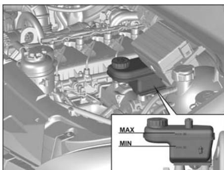
Уровень тормозной жидкости в полупрозрачном бачке главного тормозного цилиндра проверять визуально по меткам на корпусе бачка.
