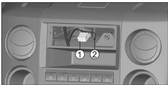
В случае отсутствия установки тахографа на предприятии-изготовителе для подключения тахографа к электрической цепи автобуса имеются два
