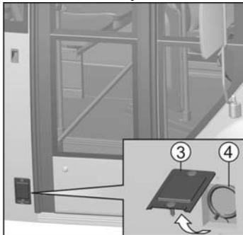
Для аварийного открывания передней служебной двери снаружи сорвите защитную крышку 3 на боковине, вытяните трос 4 аварийного открывания и удерживая его, откройте дверь вручную. Аварийный режим открывания отключается при отпусканье троса 4.
