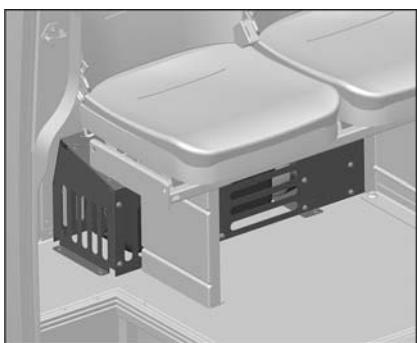
Независимый отопитель устанавливается под задним рядом пассажирских сидений. Для отопления салона используется внутренний воздух. Неоднократное прохождение внутреннего воздуха через теплообменник независимого отопителя обеспечивает высокую
