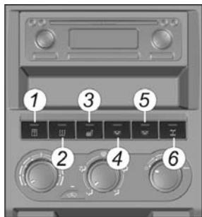
1. Выключатель открывания/закрывания передней служебной двери.
