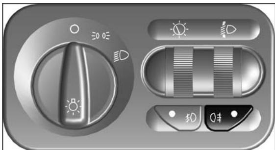
Включение заднего противотуманного фонаря происходит при нажатии на клавишу выключателя, если включены ближний, дальний свет фар или передние противотуманные фары. При этом в клавише загорается контрольный индикатор, а на комбинации приборов сигнализатор включенного состояния задних противотуманных фонарей.
