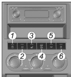
1. Выключатель открывания/закрывания передней служебной двери.
