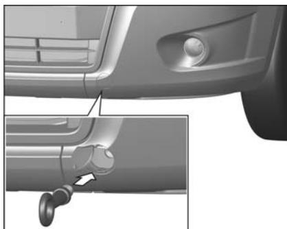
В передней части рамы к лонжеронам крепятся штампованные-сварные кронштейны. Левый кронштейн имеет приварную втулку, в которую при буксировке или вытаскивании застрявшего автобуса необходимо ввернуть рым-болт для установки троса или цепи (рым-болт
