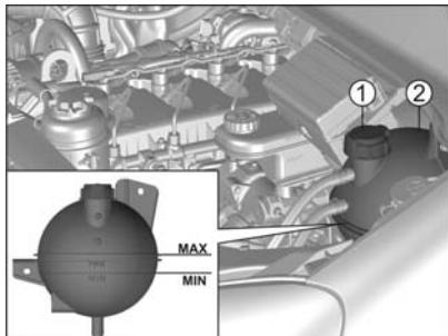
Проверку уровня охлаждающей жидкости в расширительном бачке 2 производите только на холодном двигателе.
