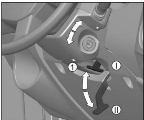
Рулевая колонка регулируется по углу наклона.
