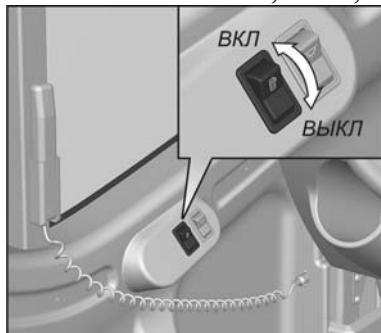
При запотевании/обмерзании наружных зеркал включите их обогрев кнопкой, установленной с левой стороны от водителя на боковине. Для включения обогрева переведите кнопку в положение «Включено», для выключения – в положение «Выключено».
