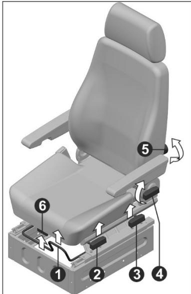
Для регулировки угла наклона спинки сиденья поверните рычаг 4 как показано на рисунке и выберите желаемое положение наклона спинки.
