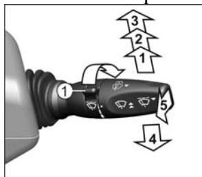
1. Очистка ветрового стекла одним рабочим ходом щёток. Переместите рычаг вверх только на величину его свободного хода (до ощущения лёгкого упругого сопротивления рычага).
