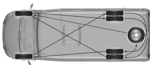
Перестановку колес рекомендуется производить через каждые 10000 км пробега (при необходимости) в соответствии с
