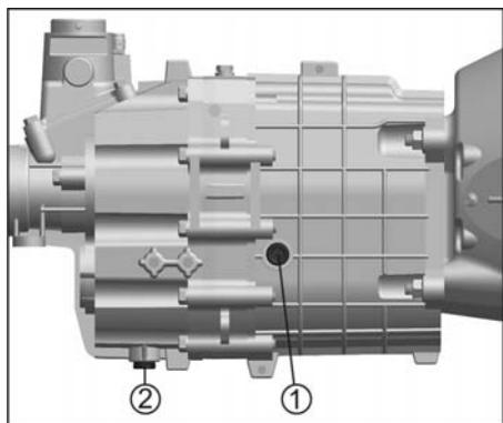
Проверку уровня масла необходимо выполнять на автобусе без нагрузки, установленном на ровную горизонтальную площадку, на остывших агрегатах.
