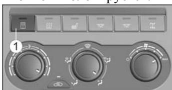
Для открывания передней служебной двери с места водителя нажмите кнопку 1 в течение не менее 1 секунды. При открытой двери включается плафон освещения дверного проема, а также сигнализатор открытой двери в комбинации приборов (при положении ключа выключателя приборов и стартера в положении I). По истечении 15 секунд плафон автоматически выключится, если дверь не закрыта. Повторное нажатие кнопки в момент открывания двери приведет к ее закрыванию.
