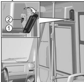
Для аварийного открывания передней служебной двери изнутри сорвите защитную крышку 1, расположенную в задней стенке кожуха привода, расположенного над дверью, нажмите вниз рычаг 2 аварийного привода и, удерживая его, откройте дверь вручную, при этом будет подаваться звуковой сигнал, свидетельствующий о том, что дверь разблокирована.
