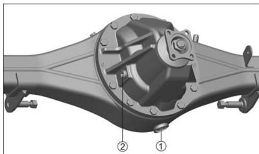
Проверку уровня масла необходимо выполнять на автобусе без нагрузки, установленном на ровную горизонтальную площадку, на остывших агрегатах.
