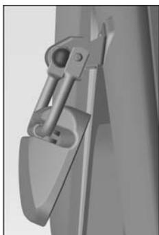
Для складывания зеркала в транспортировочное положение установите зеркало на стойке как показано на рисунках (условная плоскость стойки и оптического элемента зеркала должны быть параллельны) и сложите стойку вместе с зеркалом относительно оси вращения опор.
