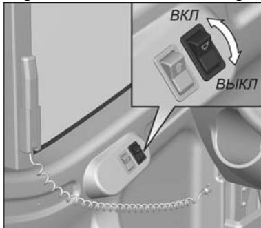
Для включения внутреннего освещения места водителя переведите кнопку включения плафона, расположенную с левой стороны от водителя на боковине, в положение «Включено». Для выключения освещения переведите кнопку в положение «Выключено».
