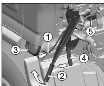
– потяните стопорную рукоятку 1 одной рукой в направлении стрелки и, поднимая откидной рычаг 2 другой рукой, снимите блокировку откидного рычага;
