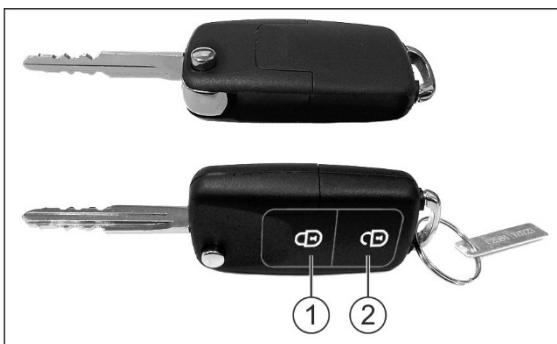
На некоторых модификациях автомобилей один из ключей имеет кнопки дистанционного управления блокировкой дверей кабинки. Для дистанционной блокировки дверей
