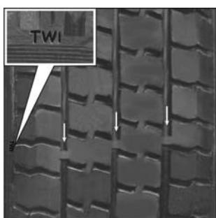
У основания протектора имеются «индикаторы износа» шин, расположенные поперек беговой дорожки протектора на одинаковом расстоянии по окружности. Местонахождение индикаторов износа показывает маркировка на боковине шины (например обозначение «TWI» или пиктограммы). Индикаторы износа
