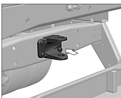
Заднее буксирное устройство состоит из буксирной вилки.
