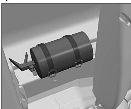
Автомобиль комплектуется огнетушителем ОП-2, который закреплен на полке задка кабины за сиденьем водителя.
