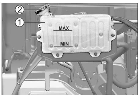
Расширительный бачок 1 находится слева за кабиной автомобиля. Проверку уровня охлаждающей жидкости в расширительном бачке производите только на холодном двигателе.
