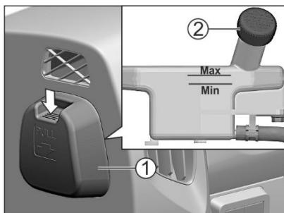
Для доступа к бачку с тормозной жидкостью главного цилиндра сцепления слева на панели приборов снимите крышку 1, потянув ее вниз в направлении стрелки. Уровень тормозной жидкости в бачке должен находиться между метками Min и Max на корпусе бачка. Заправка осуществляется через горловину бачка, закрываемую крышкой 2.
