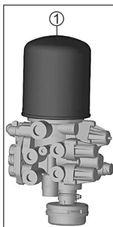
Для замены картриджа модуля подготовки воздуха:
