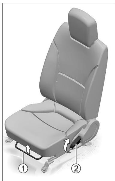
Сиденье водителя оснащается механизмом продольного перемещения, а также механизмом регулировки угла наклона спинки.
