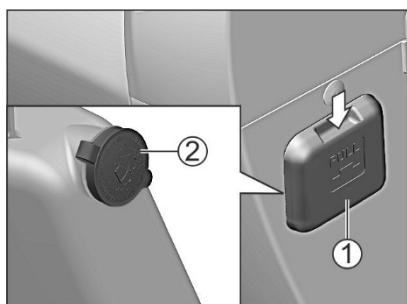
На автомобиле установлены электрические стеклоочиститель и стеклоомыватель. Управление стеклоочистителем и стеклоомывателем — совмещенное. Для доступа к бачку стеклоомывателя справа на панели приборов снимите крышку 1, потянув ее вниз в направлении стрелки. Заправка осуществляется через горловину бачка, закрываемую крышкой 2.
