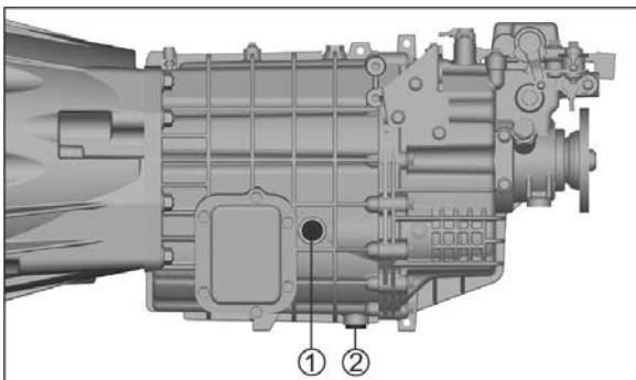
Проверку уровня масла необходимо выполнять на автомобиле без нагрузки, установленном на ровную горизонтальную площадку, на оставшихся агрегатах.
