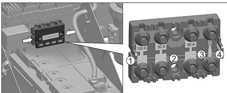
Для доступа к предохранителям прижмите две пластмассовые защелки по бокам крышки и снимите крышку.
