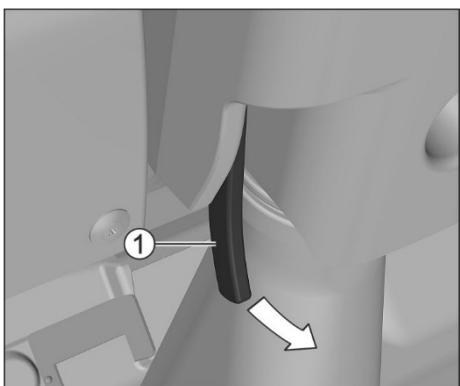
Водитель может отрегулировать положение рулевой колонки в пределах доступного диапазона в соответствии со своими привычками.
