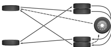
Перестановку колес следует производить по необходимости в соответствии с рисунком. Основанием для перестановки колес могут служить
