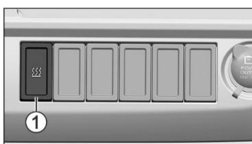
Догреватель включается кнопкой 1 при работающем двигателе и включенном отопителе. Далее догреватель работает в автоматическом режиме, повышая температуру теплоносителя, поступающего в систему отопления
