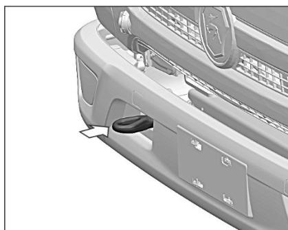
В передней части рамы к правому лонжерону крепится кронштейн, в который при буксировке или вытаскивании застрявшего автомобиля необходимо ввернуть рым-болт для установки троса или цепи (рым-болт прикладывается к автомобилю).
