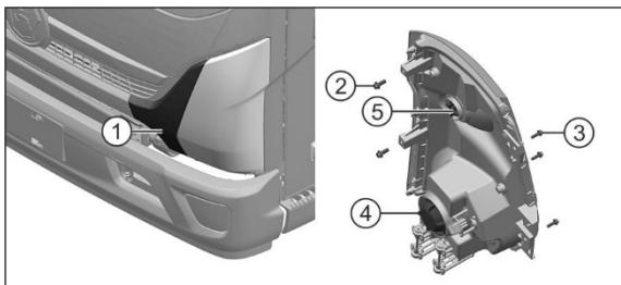
Для этого отщелкните переднюю декоративную панель 1, отверните два винта 2 крепления фары сзади (доступны при открытой двери со стороны снимаемой фары) и три винта 3 крепления фары спереди. Выдвиньте фару на небольшое расстояние, снимите соединительную колодку жгута проводов и извлеките фару. После замены перегоревшей лампы, установите фару в порядке, обратном снятию. Заверните винты 2 крепления фары – с моментом 1,2-1,8 кгс м, винты 3 – с моментом 0,55-0,8 кгс м).
