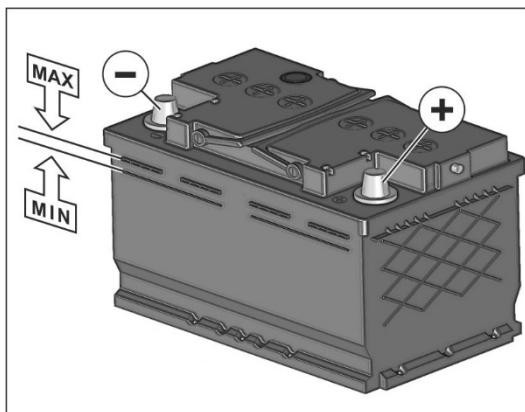
В нормальных условиях эксплуатации батарея почти не требует ухода. Однако, при высокой температуре наружного воздуха, рекомендуется регулярно проверять уровень электролита. Во всех секциях он всегда должен находиться между
