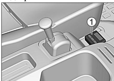
На консоли справа от водителя установлен модуль 1 управления предпусковым подогревателем.
