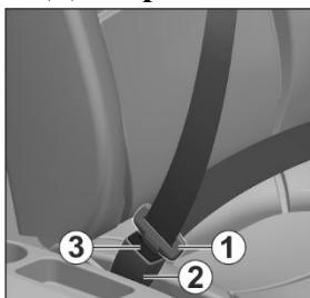
ленту ремня за язычок 1, чтобы её длина по груди и бёдрам была примерно одинаковой, и вставьте его в соответствующий данному сиденью замок 2 до характерного щелчка.
