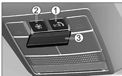
В УВЭОС входит кнопка 1 экстренного вызова «SOS», кнопка 2 дополнительных функций, расположенные в блоке освещения салона, а также блок управления, расположенный под панелью приборов. В блоке освещения
