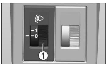
На панели приборов слева от рулевого колеса находится регулятор корректора фар 1, который позволяет при включенном ближнем свете фар корректировать угол наклона пучка света в зависимости от загрузки
