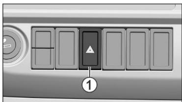
При нажатии на кнопку 1 выключателя одновременно горят в мигающем режиме все указатели поворота.
