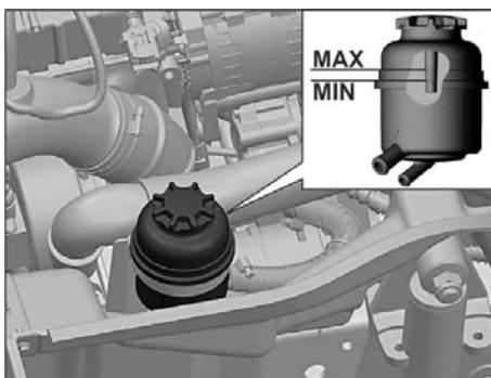
Уровень масла в бачке должен быть между метками, нанесенными на щупе крышки, обозначающими допустимый максимальный и минимальный уровень масла, при завернутой до упора крышке. Проверку уровня масла в бачке производите на холодном двигателе.
