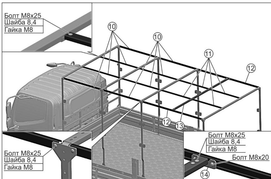
Соедините рейки дуг тента 10 и 12 со стойками и дугами тента, закрепив их болтами.
