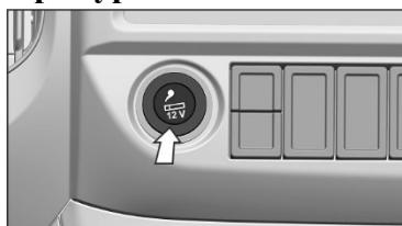
Чтобы воспользоваться прикуривателем, утопите его до фиксированного положения. При этом ключ зажигания должен находиться в положении ACC или ON. После нагрева спирали он
