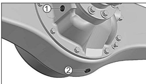
Проверку уровня масла необходимо выполнять на автомобиле без нагрузки, установленном на ровную горизонтальную площадку, на остывших агрегатах.
