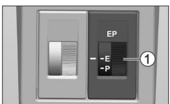
На некоторых комплектациях автомобилей слева от рулевого колеса на панели приборов находится переключатель 1 режимов работы двигателя (EP). С помощью данного переключателя можно выбрать один из двух режимов работы двигателя: экономичный (E) или стандартный (P).
