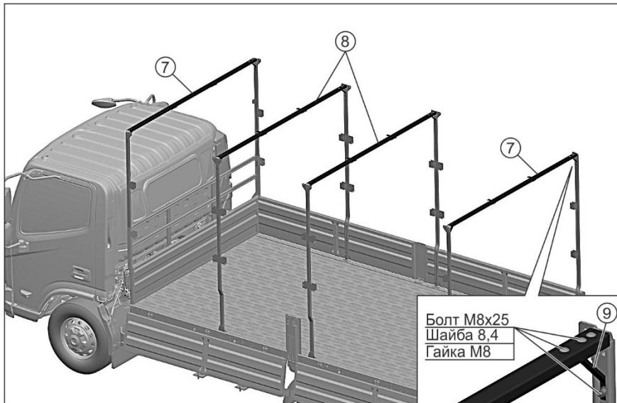
Соедините дугу тента переднюю 7 со стойками тента передними с помощью болтов, а затем через раскосы 9, закрепив их болтами.
